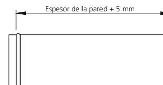
Tubo de salida de gases quemados FIG. 7
