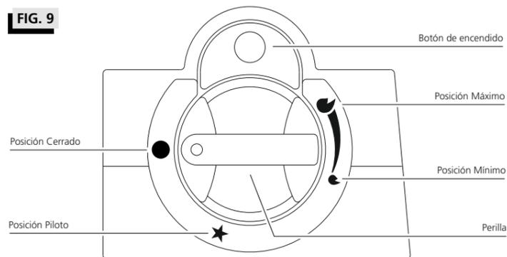
(\*). Este es el tiempo necesario para activar la válvula de seguridad incorporada en todos los calefactores ORBIS. Si por cualquier causa se apagase el calefactor, esta válvula corta totalmente el paso de gas, garantizando la máxima seguridad durante el uso.
